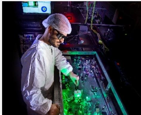
*La génération d'harmoniques d'ordre élevé est un processus extrêmement non-linéaire qui peut être observé lorsqu'un solide cristallin interagit avec une impulsion laser ultra-courtes et intenses. Elle se traduit par l'émission d'un rayonnement cohérent composé de tout un ensemble d'harmoniques de la fréquence du laser de génération.*
